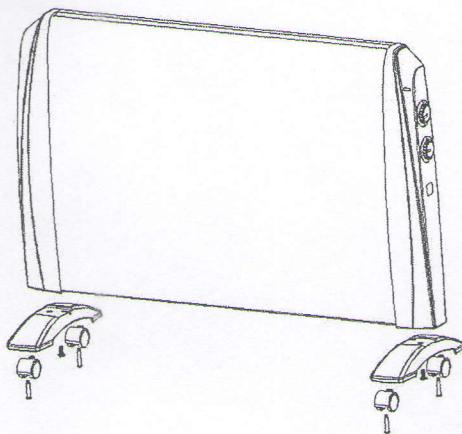
Inainte de a pune in functiune convectorul radiant va rugam sa va asigurati ca ambii suporti de sol sunt fixati corect si ferm cu ajutorul suruburilor.
